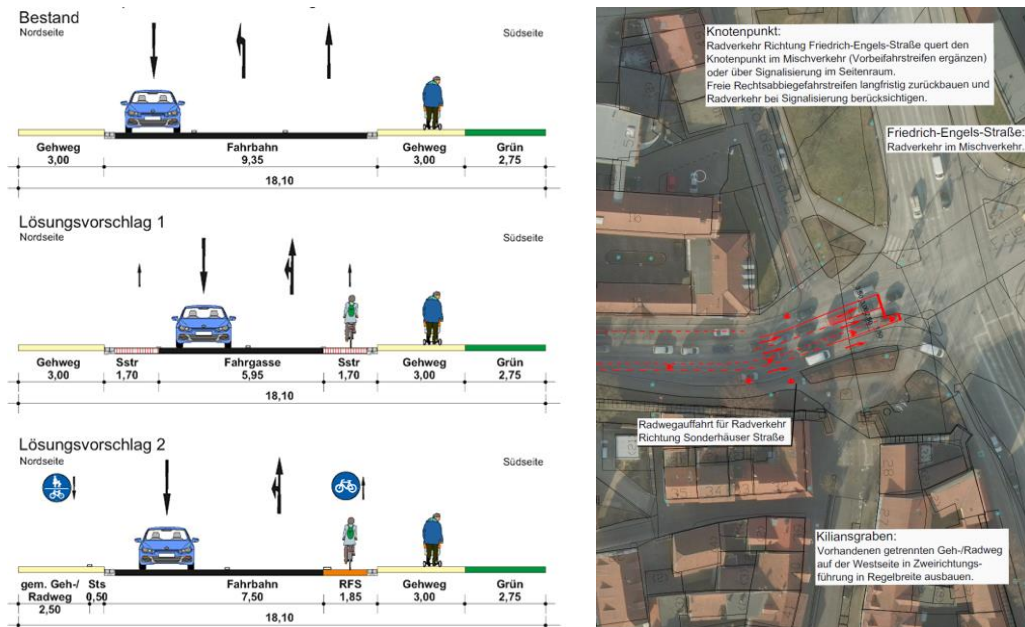
Abb. 4-31: Querschnitte Abschnitt Kreuzgraben und geänderte Radverkehrsführung am Knoten Friedrich-Engels-Straße (Luftbild: Stadt Mühlhausen). Im Rahmen des Maßnahmenkonzeptes wurden weitere Lösungsansätze aufgezeigt, die allerdings dem Ziel der Stadt Mühlhausen, den Radverkehr zu fördern, nicht zuträglich sind oder größerer baulicher Anpassungen bedürfen.
