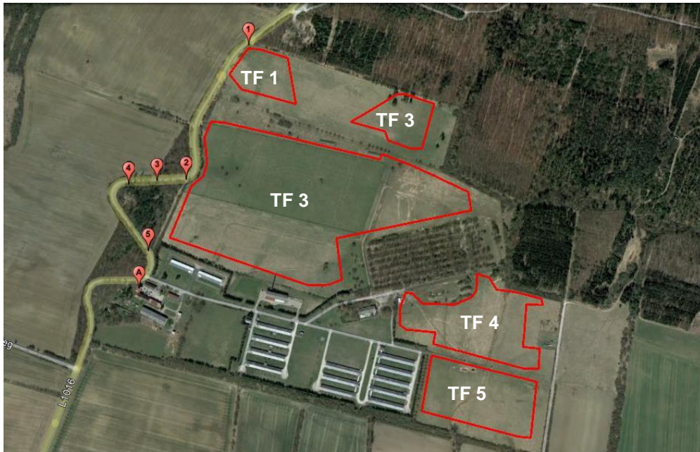
Bild 1a: Übersicht der geplanten PV-Anlage Schröterode mit den Teilflächen TF 1 bis TF 5, den Markierungen 1 bis 5 auf der L 1016 sowie Markierung A für den Immissionsort Schröterode 1
