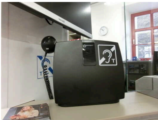
Induktionsschleife an der Kasse
